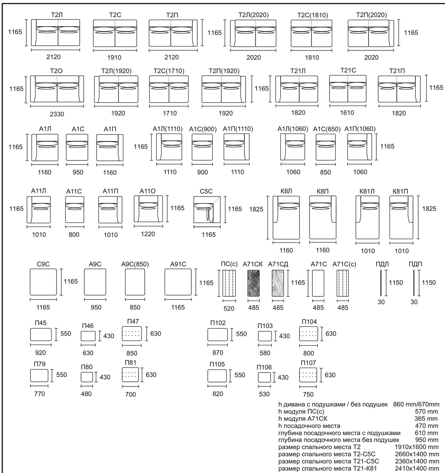
Согласно ГОСТ 19917-2014: для мебели, габаритные размеры которой определяются размерами мягкого элемента, предельные отклонения от габаритных размеров не должны превышать +/- 20мм.
